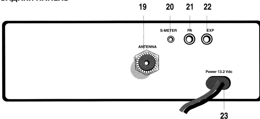
19. **Разъем ANTENNA (тип разъема SO239)**
